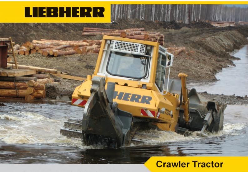
150 KW / 204 HP 17,960 - 22,100 kg توان موتور وزن عملیاتی PR 734 Litronic
